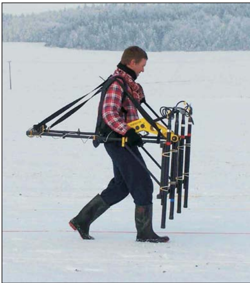
Geomagnetische Messung mit einem Mehrkanalsystem, Typ Ferex Gradiometer
